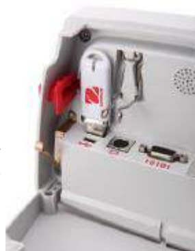
Gniazda interfejsu z tyłu terminalu
